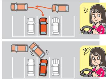
後退駐車時、ハンドルを自動制御して駐車を補助する装置です。
