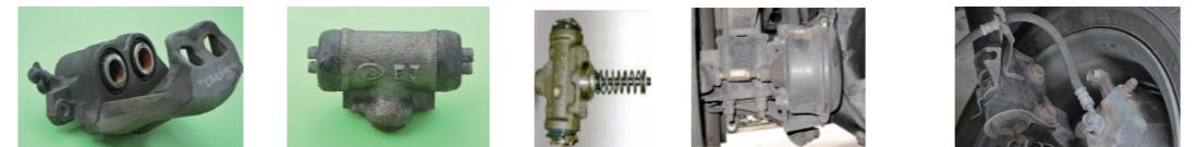
各種ゴム部品類の劣化・膨潤からシール性が失われ、倍力機構が働かず停止距離が長くなる。またブレーキの引きずりを起こし、最悪、車両火災に至る可能性があります。
